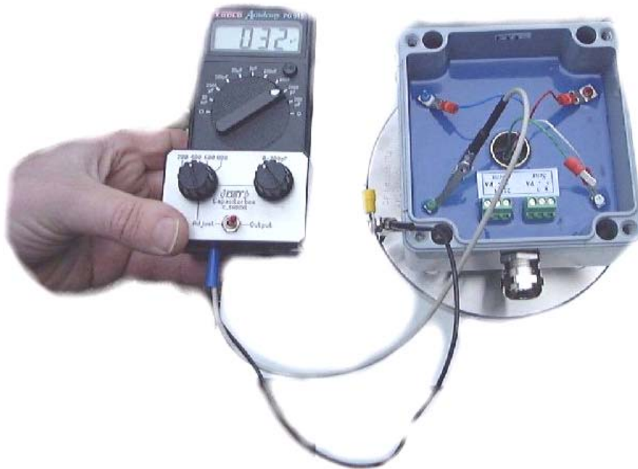
Fig.6 Gebruik van de capaciteitssimulator 1) de afgebeelde simulator wijkt af van de direkt instelbare, drienumerige uitvoering (zie fig.7)
