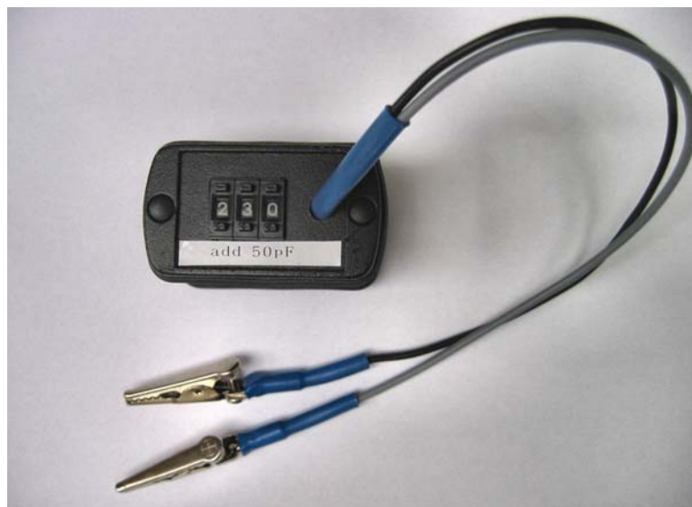
Fig.7 direkt instelbare, drienumerige capaciteitssimulator
